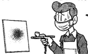
吹きはじめに塗料が斑点(スポット)状に飛び散る!
