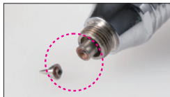
▲ノズルのネジ山が折れてしまった時
