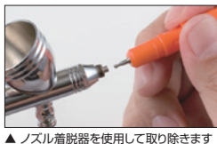
▲ノズル着脱器を使用して取り除きます
